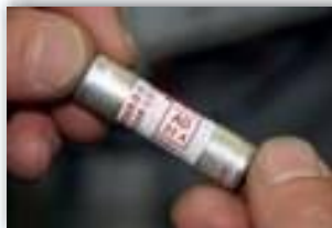
aD Couleur Rouge - Circuit de distribution, utilisé par EDF par ex.
